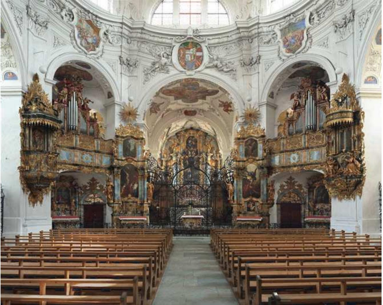
Beide Orgeln verfügen über Manual und angehängtes Pedal mit kurzen Bassoktaven und originale Windversorgungen mit je 3 fünffaltigen Keilbälgen. Die Instrumente besitzen eine modifizierte Werckmeister-Stimmung (Quintenzirkel geschlossen); ihre gleiche Stimmtonhöhe ermöglicht alternatives und gemeinsames Musizieren.
